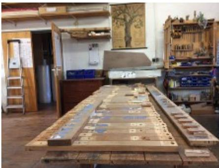
*Originale Bälglöcher mit bereits abgelöstem Provisorium (links) und einer Bälglöcherleiste des Relais (rechts)*
