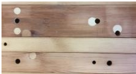
Aufgearbeitete Bälghenleisten mit verschlossenen nicht originalen Löchern
