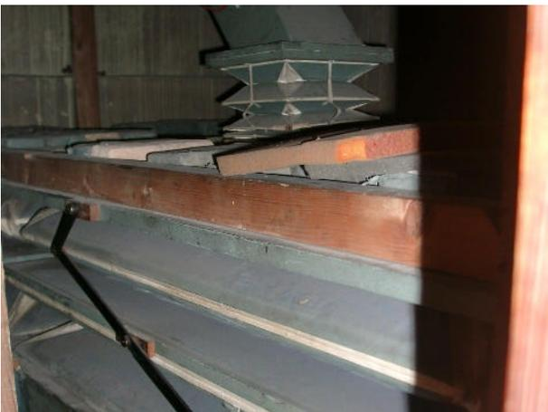
*Blick auf den Blasebalg, der mit einem elektrischen Gebläse aufgeblasen wird und für einen gleichmäßigen Luftdruck sorgt.*
