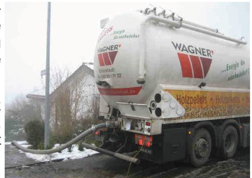
Tanklastzug mit Pelletsladung. Sie werden per Schlauch in den Speicher geblasen.
